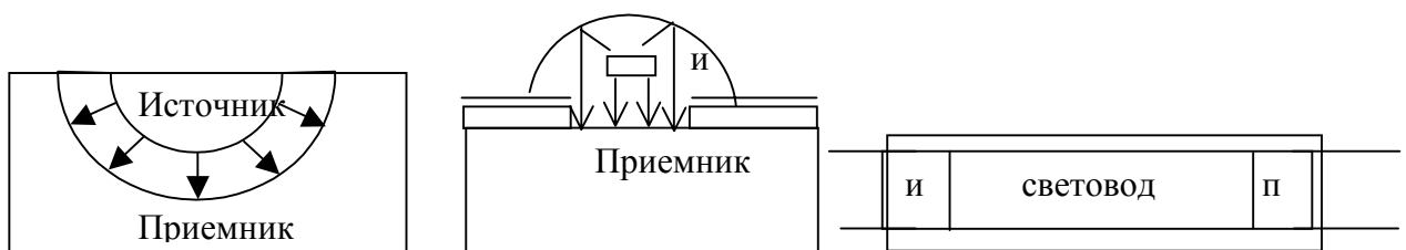
Рис. 4.3. Конструкции оптопар с более эффективной передачей излучения.
