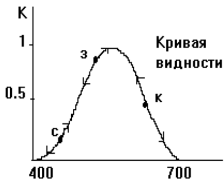
Рис. 4.1. График относительной спектральной световой эффективности излучения K(\lambda) (точки с, з и к соответствуют синему, зеленому и красному цветам).
