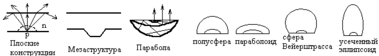
Рис. 2.8. Конструкции излучающих диодов.
