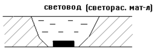
Рис. 5.5. Структура индикатора со светорассеивающим материалом.
