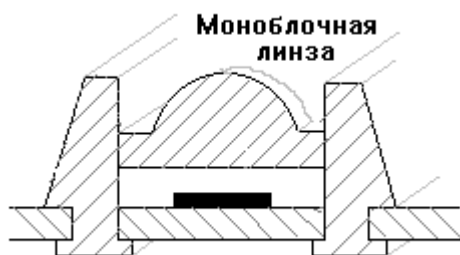
Рис. 5.4. Конструкция индикатора с моноблочной линзой.
